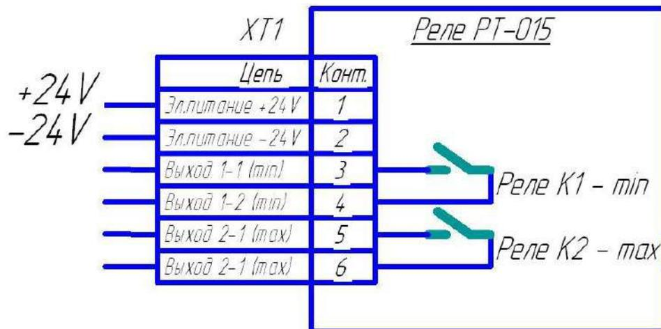
Рис.2. Распределение цепей выходной колодки ХТ1 реле РТ-015.
